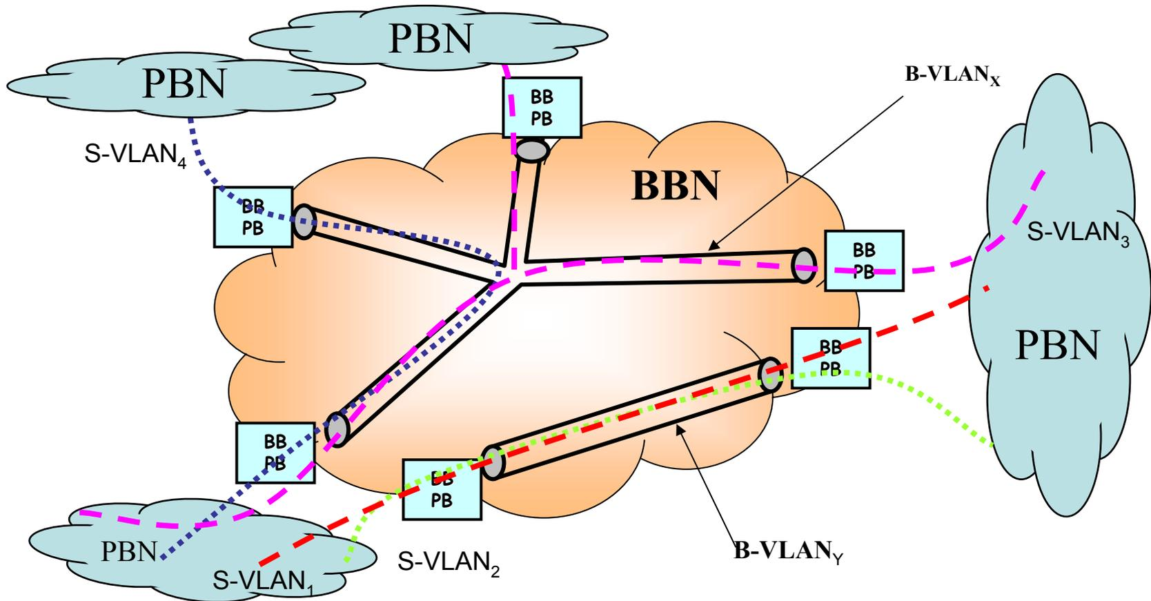
• **BB PB**: Backbone Provider Bridge Edge
