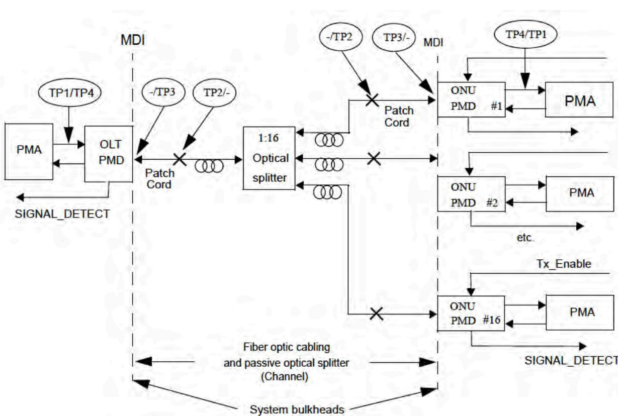
Figure 60-2—1000BASE-PX block diagram
