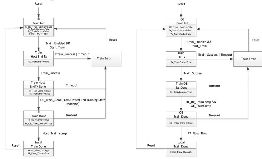
Tx\_TrainCmd = Tx\_TTS\_Control[6] Tx\_TrainComp = Tx\_TTS\_Status[13] Tx\_OE\_Train\_comp= Tx\_TTS\_Status[6] Host\_Train\_comp = Rx\_TTS\_Status[15]
